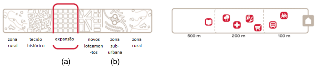
Figura 6.5 – Indicadores urbanos para avaliação de projetos de habitação: (a) inserção urbana da edificação e (b) equipamentos presentes no seu entorno (Fonte: adaptado de ESPANHA, 2006)
