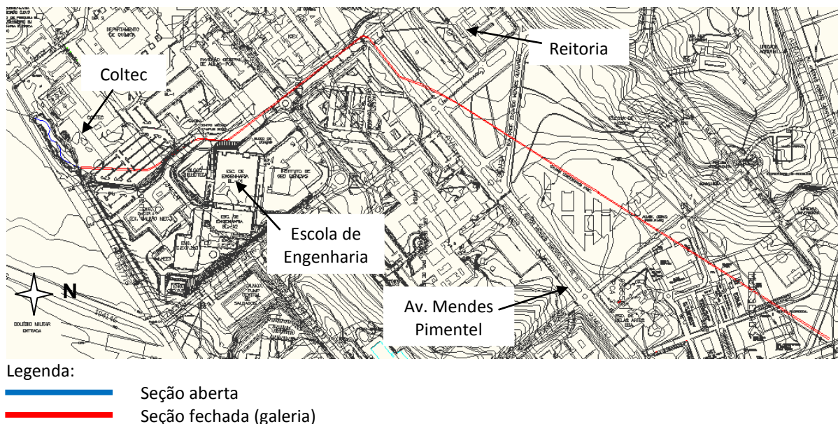
Figura 9.4 – Rede de macrodrenagem do Córrego Engenho Nogueira dentro da área do campus da UFMG (Fonte: adaptado de DFPF/UFMG – Plano Diretor de Infraestrutura/2012)
