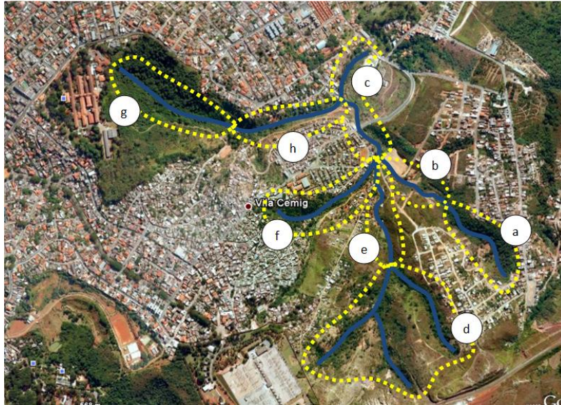
Figura 14.2 – Imagem de satélite da rede de drenagem em estudo dividida em trechos homogêneos (Imagem: adaptado de Google Earth , 2010)
