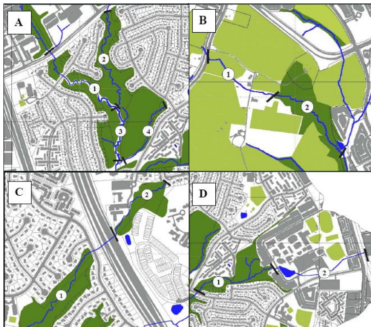
Figura 8.4 – Divisão de cursos de água em trechos homogêneos em função de: (a) confluência de tributários; (b) trechos de dimensões aproximadas; (c) existência de cruzamento viário de porte; (d) mudanças significativas no uso do solo (Fonte: CWP, 2005b)
